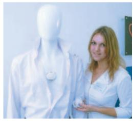
IntelliPatch (foto a sinistra) è un sensore che, indossato da persone con problemi di cuore. trasmette i dati a un centro di monitoraggio che rileva i malfunzionamenti cardiaci.
